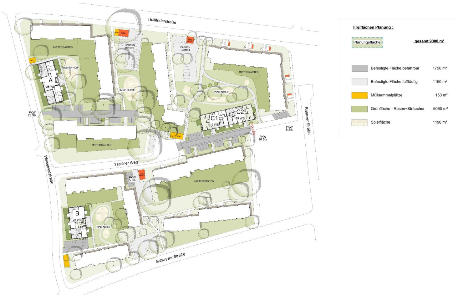
Abbildung 2 Infrastruktur und Freianlagen
