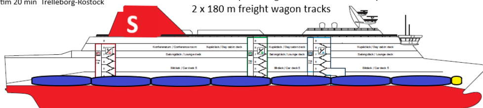
Figur: Idéskiss RAILPAX spårlagd Snabbfärja av Gotlandsklass med växlingsrobotar för snabb av- och pålastning, som ett exempel på nytt tonnage mellan Trelleborg och Rostock dimensionerad för antingen ett heltåg för gods med tysk standard 740 meter eller ett persontåg med max 14 vagnar och då med ett ½ godståg
