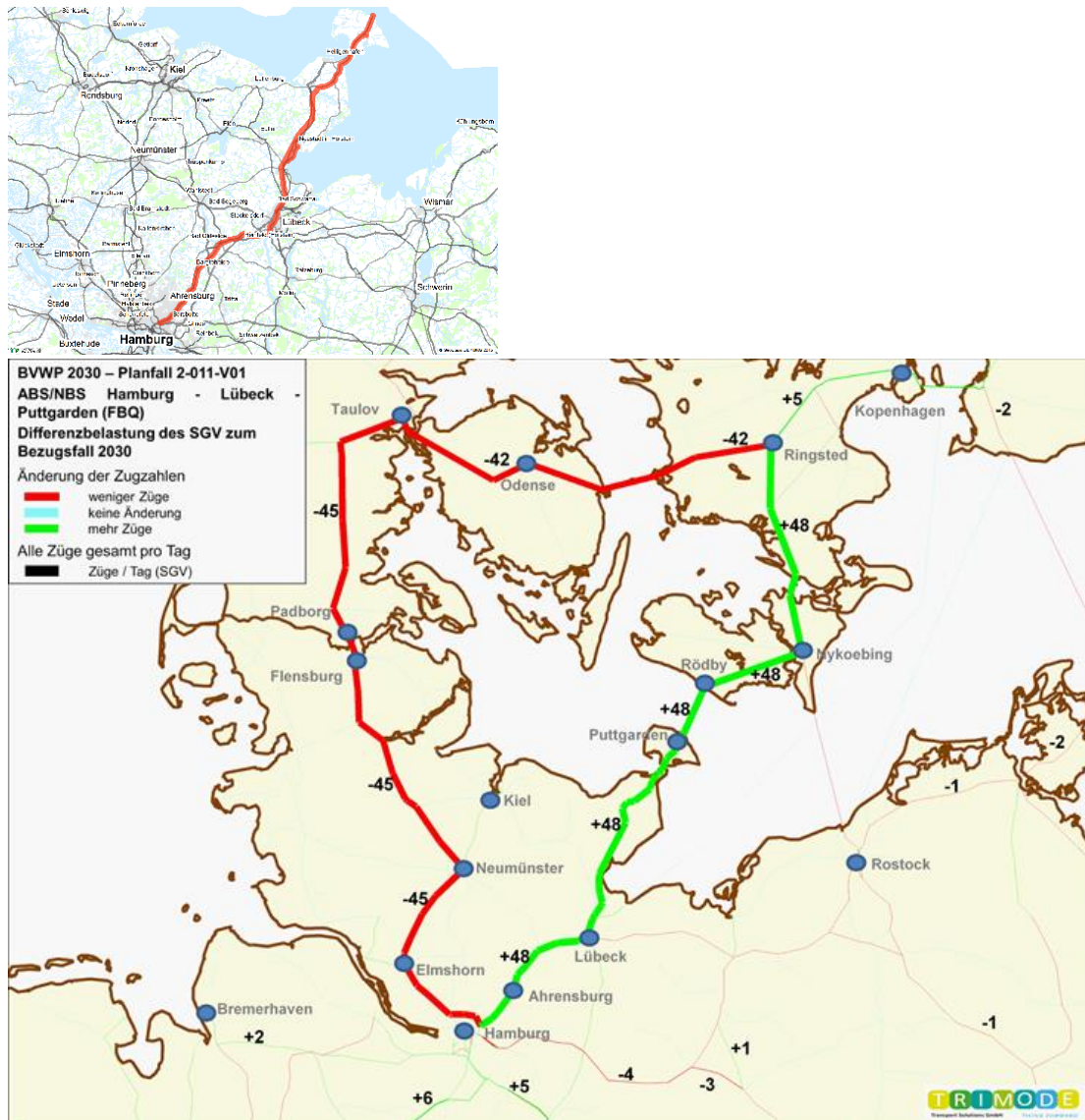
Figur: Skillnad i kapacitetsbelastning 2030 med antal tåg per dag på järnvägsnätet i norra Tyskland med utbyggnad av den fasta förbindelsen via Fermern Bält med tillhörande utbyggnader av den anslutande infrastrukturen, illustrerad i tre olika standardklasser; grön – fler tåg, röd – färre tåg och blå- i stort sett oförändrat tågantal. Källa: BVWP 2017 - 2030, Ministeriet för transport och digital infrastruktur
