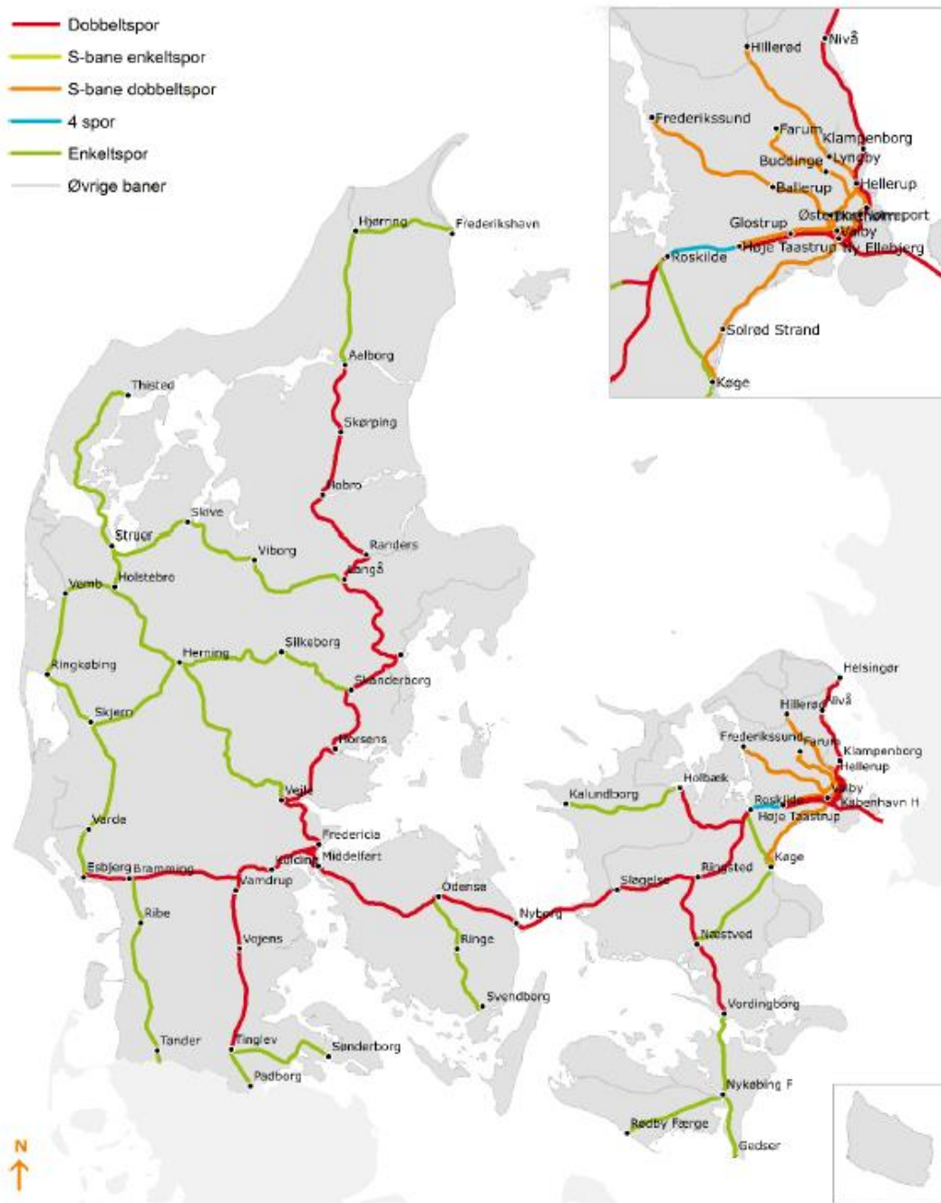
Figur: Järnvägsnätet i Danmark 2016. En ny bana mellan Köpenhamn/Ny Ellebjerg - Køge Nord- Ringsted har öppnats 2019. Källa Trafikplan Danmark 2017-2032, Trafik-, Bygge- och Boligstyrelsen
