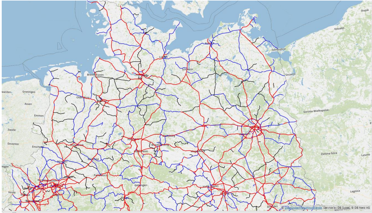
Figur: Järnvägsnätet i norra Tyskland med tre olika standardklasser; dubbelspår – röd, enkelspår-blå och sidospår-svart. Källa: Interaktiv karta DBAG.
