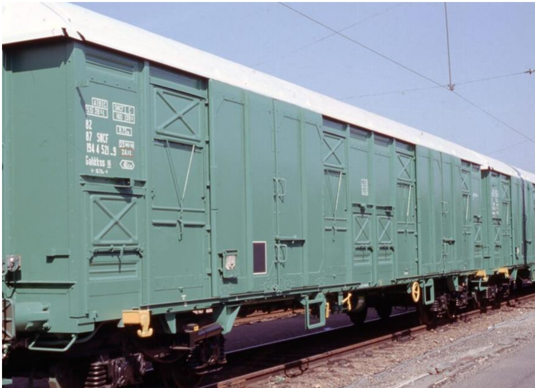
Figure 34 : Wagon couvert Gahkks 16 160 km/h avec sa nouvelle décoration.
