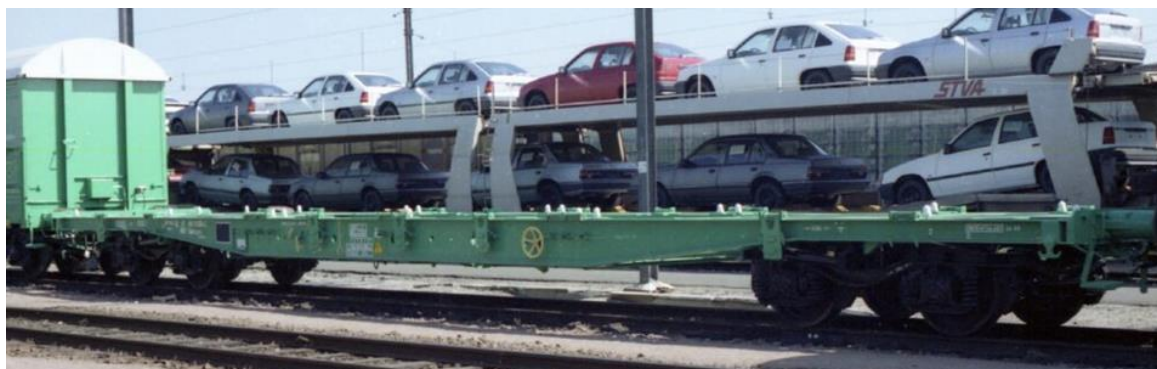
Figure 35 Wagon plat S61 porte container autorisé à 160 km/h
